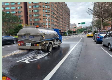
抽取沉沙池裡的水進行工地灑水並達成回收再利用(淡江大橋)
