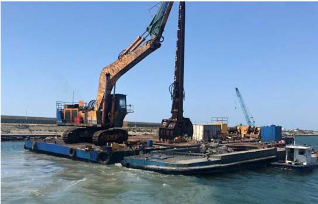
▲圖 11 施工團隊創新研發之 PC1600 三節式油壓抓斗海上浚挖平台船。
