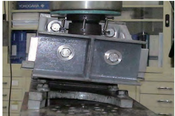
導電軌絕緣體機械強度測試
