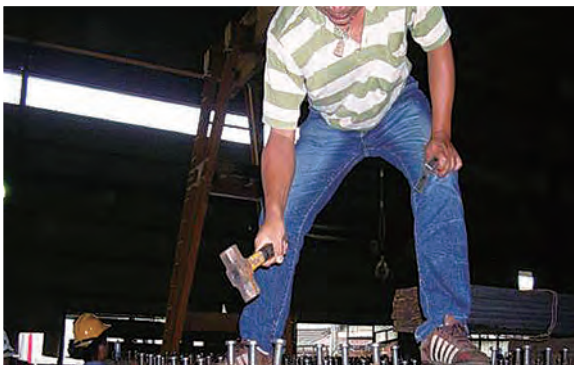
剪力釘錘擊測試
