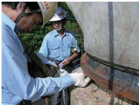
上下連接銲銲道非破壞檢測
